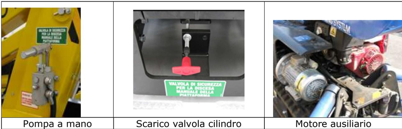
*Sistema di emergenza sostitutivo dell'azionamento principale*
