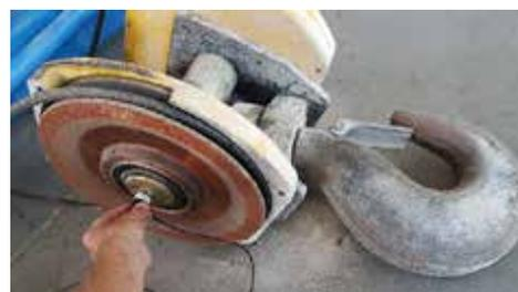
Lo Studio inoltre dispone dell'attrezzatura specifica AMC Instruments per l'**esame MRT delle funi di sollevamento** (Magnetic Rope Test) per carriponte, paranchi, gru, autogru, ecc, condotto in base alla nuova norma UNI ISO 4309.
